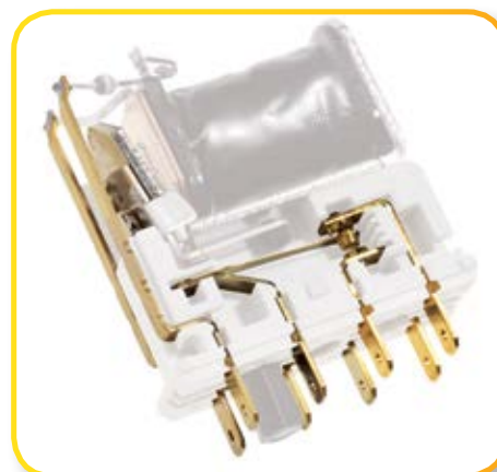
Relè POK con contatti e terminali dorati, bobina tropicalizzata
